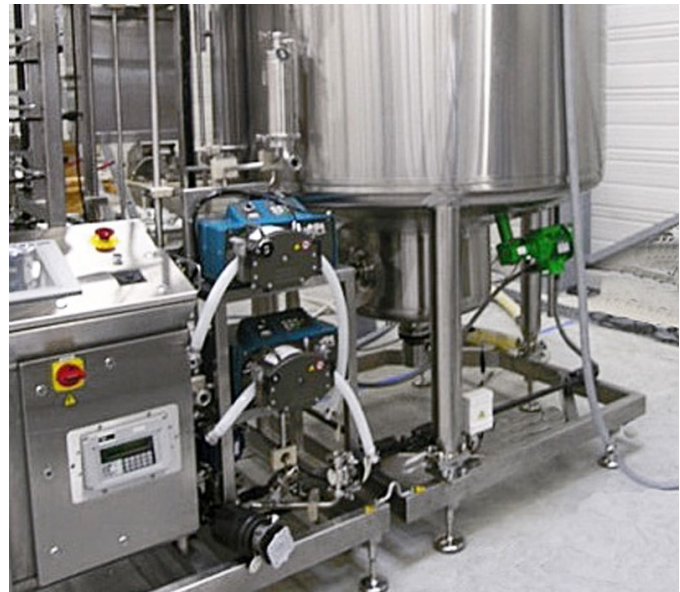
Die Load Disc Wägesysteme können auch unter Wechsel-tanks oder andere Prozessbehälter installiert werden und machen aus Ihrem Behälter eine Präzisionswaage
