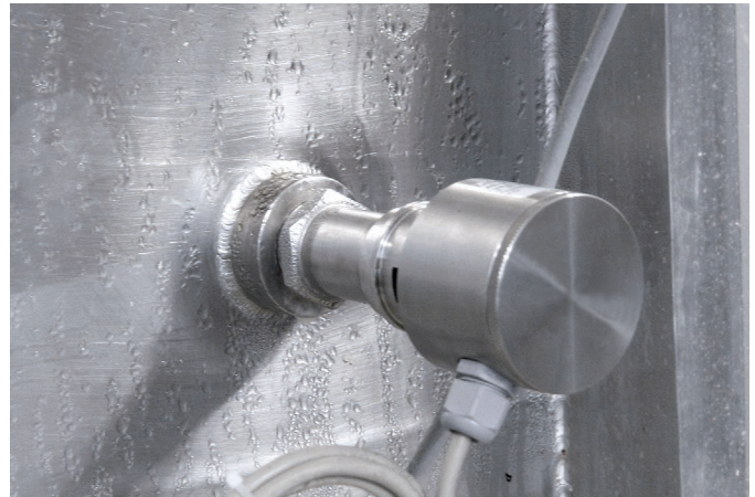
Le système de mesure spécial du LAR, hermétiquement fermé, est entièrement protégé contre la condensation ou l'humidité.
