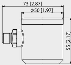
Kopfeinheit mit 1 Transmitter (ohne Display) und Kabelverschraubung
