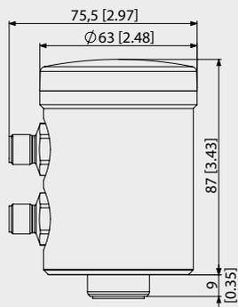
Kopfeinheit mit 1 Transmitter, Display und M12-Stecker
