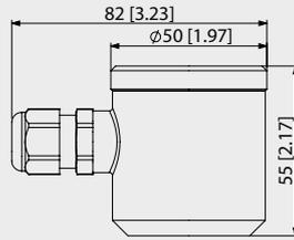
Kopfeinheit horizontal mit 1 Transmitter und M12-Stecker (Display optional)
