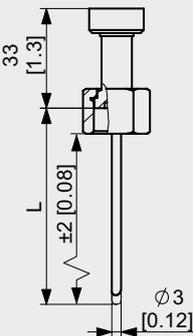
M04 | Sensor G3/8" Überwurfmutter, Ø 4 mm
