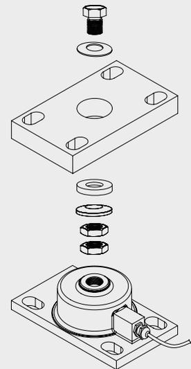
**Typische Load Disc Einbausituation
