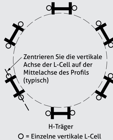
Abbildung 3-1 Anordnung für die L-Cell Montage
