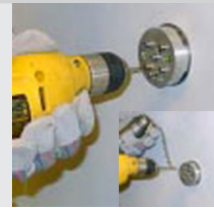
Abbildung 5-21 weitere Montagelöcher bohren
