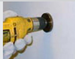
Abbildung 5-18 Oberfläche fein schleifen
