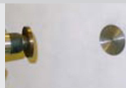
Abbildung 5-18 Oberfläche fein schleifen
