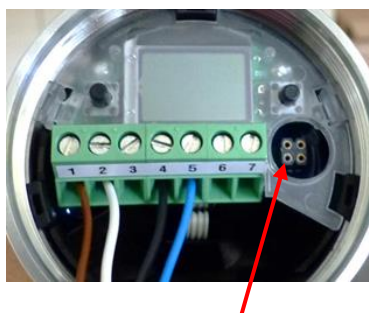
Anschlussstecker für MPI-200-F Adapter als Zwischenstecker zwischen ILM-4 Elektronik und MPI-200 Anschluss 3 (siehe Bild rechts)
