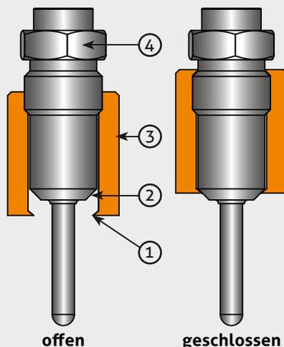
**Definierte Position der Kabeleinführung**
