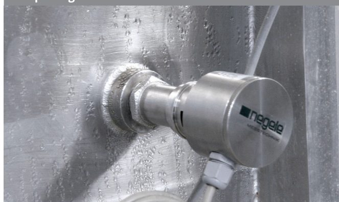
Formation de condensat sur le capteur de niveau de remplissage monté
